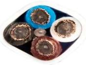
Costruzione quad-coax, isolato PP. I fili placcati in alluminio contribuiscono ad un migliore suono minimizzando l'effetto pelle. SUPRA Quadrax è fatto con un passo dell'avvolgimento molto corto per una bassa induttanza e basse radiazioni emesse. € al mt | 1000000743 | QUADRAX 4X2.0 BLUE B100 | 100   | € 25,00 |
