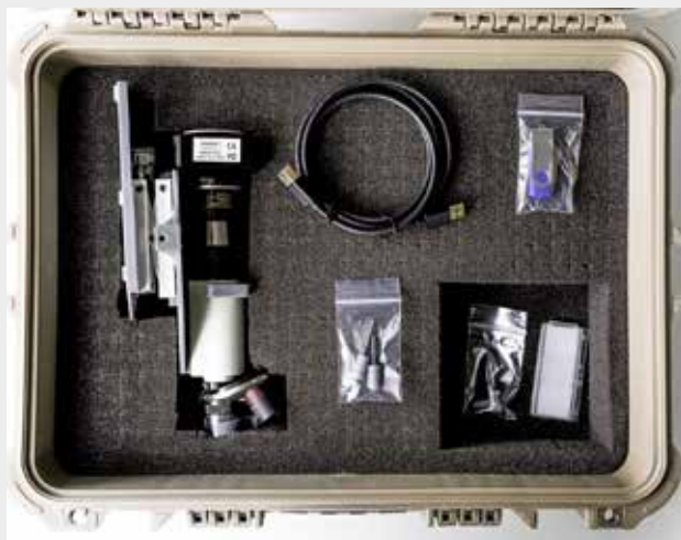
Il WallyScope è un set che prevede un microscopio di precisione che permette di misurare l'angolo di inclinazione della puntina in modalità dinamica (SRA) e l'angolo di tracciamento verticale in modalità dinamica (VTA) della testina.
